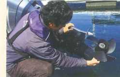
プロペラは手で回してみる。海上で行う場合はライフジャケット着用で行い、落ちないように気をつける
