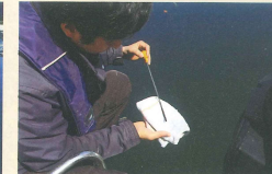
抜いたオイルレベルゲージを一度布で拭き取ってから戻し、10秒後に抜くと正確に確認できる
