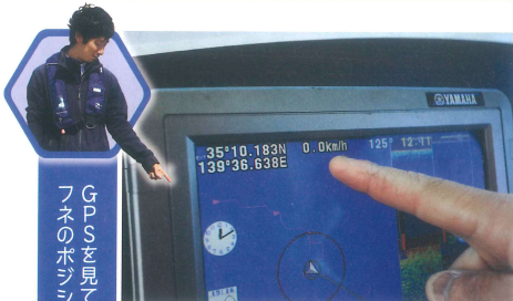
アンカーがしっかり効いていれば、速力はほぼ0になる。また、航跡もほぼ伸びず、カクカクした状態になる
