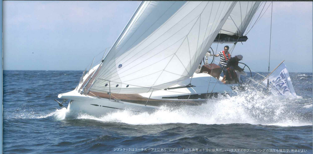
ジブトラックはコーチルーフ上にあり、ジブの引き込み角度は十分に鋭角だ。バックステイやフームバングの油圧も強力で、利きが良い
