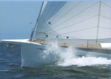
最近ステムの丸いデザインが出てきているが、このシャープなエントリーは、波切りだけでいえば抵抗は少ないだろう
