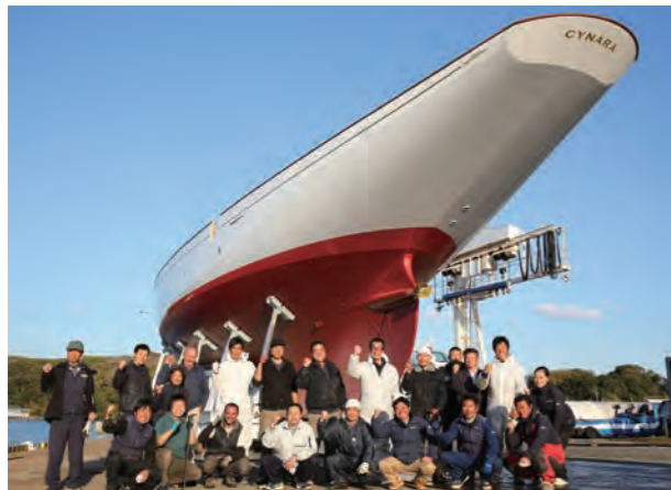
シナーラを海に浮かべるため、船体をクレーン船で吊り上げる方法が探られた。難関は作業テントから水際までの陸上移動。特別に組んだ船台に船を載せ、グリースを塗った鉄板上を引きずるようにクレーン車で引いて僅かずつ動かした。チームワークが光る一日だった
