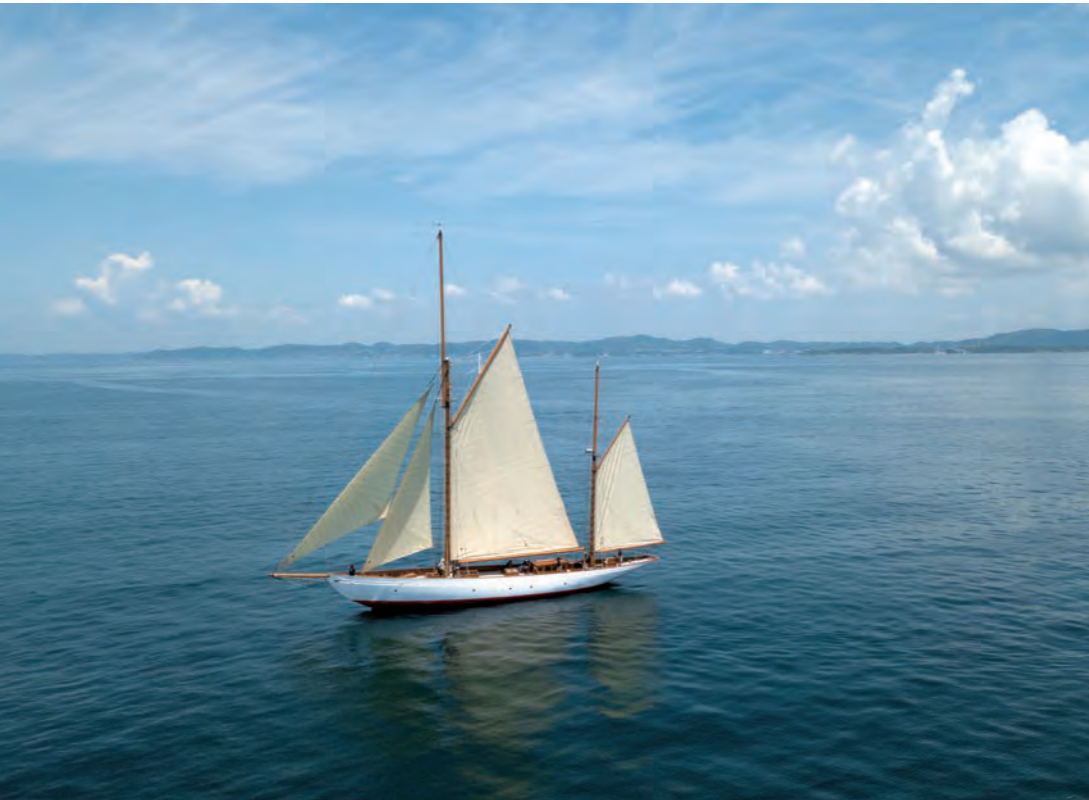
5月30日、初めてのテストセーリング。メインセール、ミズンセール、ステイスル、ジブの4枚が展開された photo / Mattis Voss
